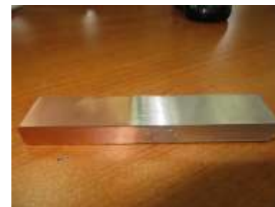
Сварка трением с перемешиванием сварка меди и алюминия
