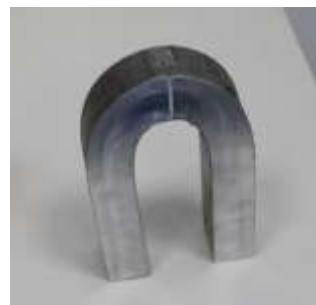
Внешний вид образца после испытаний на статический изгиб
